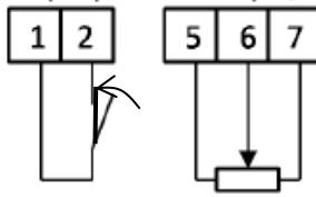
Подключите потенциометр (5кОм – 10кОм) к клеммам 5, 6, 7 для регулировки скорости привода от P-2 (0Гц) до P-01 (50 / 60 Гц по умолчанию)
